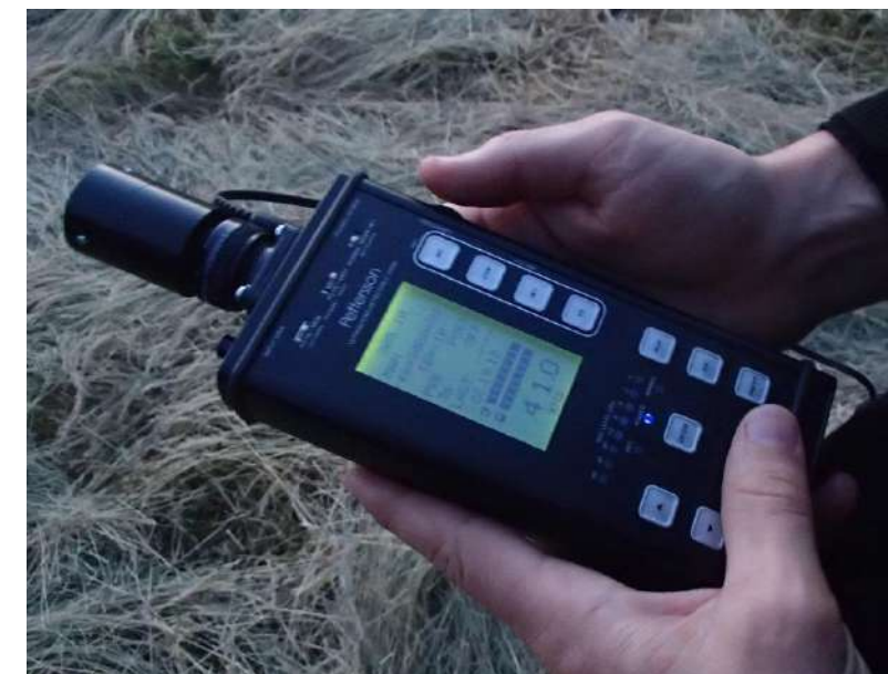
Figure 11 : Exemple de Point d'écoute de 15 à 20 min à la batbox Pettersson D1000X – Photographies prises hors site
